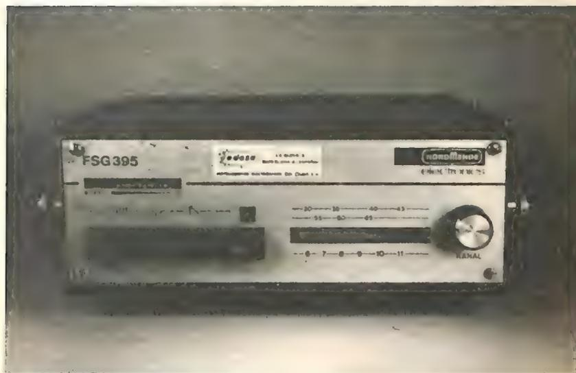
Fig. 8.-Modello molto semplificato di generatore video, con possibilità di ottenere quattro segnali di base.
