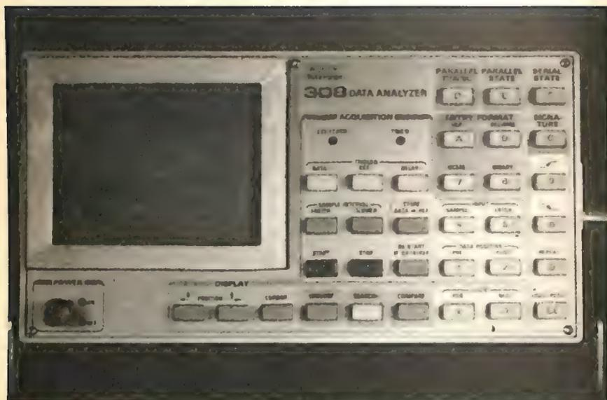
*Fig. 16.-Aspetto di un analizzatore logico in un modello convenzionale, nel quale tutti i controlli si effettuano con la tastiera.*
