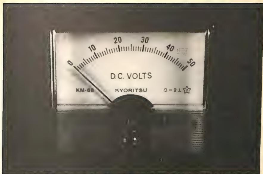
Fig. 4.-Voltmetro a bobina mobile, adatto solo per misure in tensione continua. Scala da 0 a 50 V. Contenitore grande.
