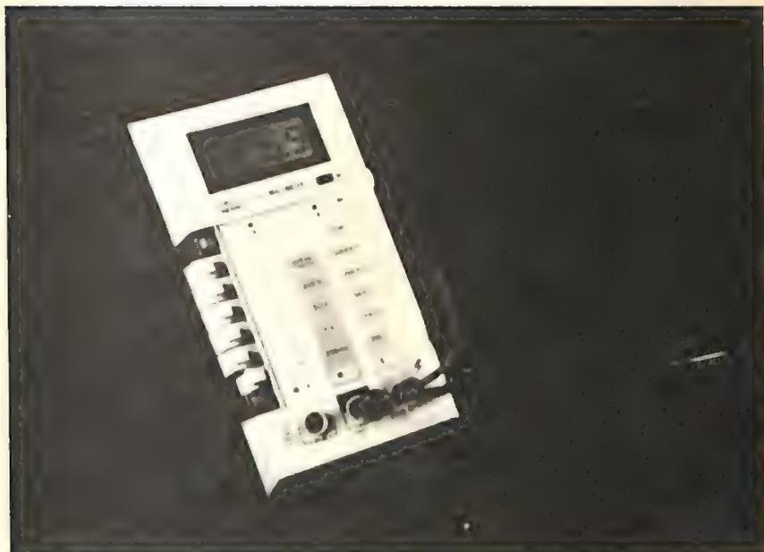
*Fig. 7.-Tester digitale portatile con alimentazione a batterie.*
