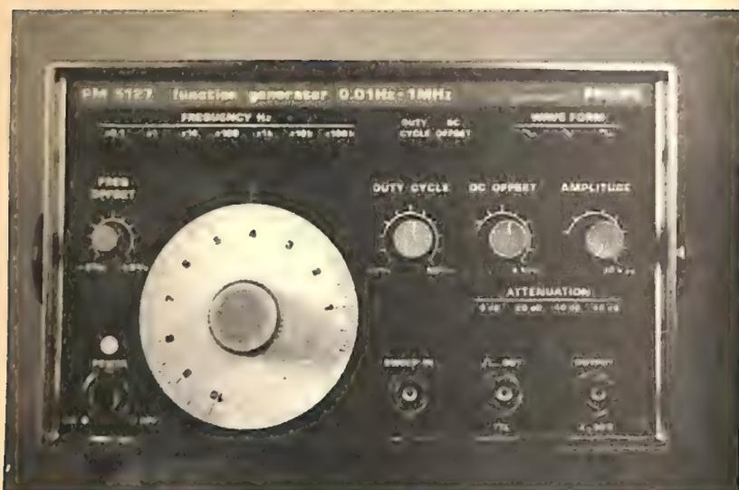
*Fig. 1.-Generatore di funzioni di tipo medio. Questo modello può generare le tre forme d'onda di base: sinusoidale, triangolare e quadra.*
