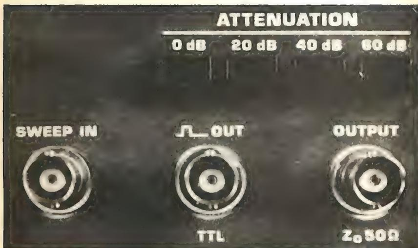
Fig. 6.-Dettaglio dei connettori di ingresso e di uscita. Quello di sinistra si utilizza per l'ingresso del segnale esterno di spazzolamento, e gli altri sono le due uscite: una speciale per l'onda quadra e l'altra generale.
